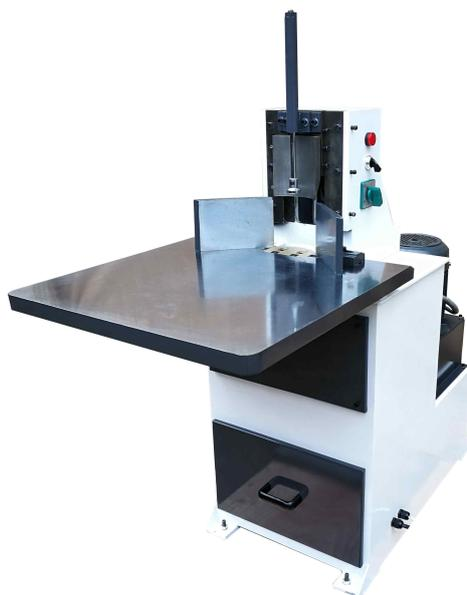
4脚踏式开关操作，控制刀头工作行程，简便、省力、高效、安全。5离合控制，裁切力度大，其他机型无法比拟。6用于笔记本，精装书，纸张、纸板、PVC.包装袋,软包装,吊牌等多种软性材料的圆角切割。是制作相册、菜谱、影册、标书、商标等印后加工的配套设备。脚踩脚踏开关，离合器带动圆角冲下切角，操作简便省力高效。厂家直销（温州旭日印刷机械有限公司），一级制造商,生产,售后,品质服务20年。
