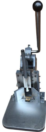
产品特性/主要规格/特殊功能： 1. 立式设计，结构紧凑，使用方便。 2. 刀具自选，规格齐全 3. r2.5-r12 12种常规刀具，其他规格均可定制。 4. 脚踏式开关操作，控制刀头工作行程，简便、省力、高效、安全。 5. 离合控制，裁切力度大，其他机型无法比拟。 6. 用于笔记本，精装书，纸张、纸板、pvc.包装袋, 软包装, 吊牌等多种软性材料的圆角切割。 7. 是制作相册、菜谱、影册、标书、商标等印后加工的配套设备。 8. 脚踩脚踏开关，离合器带动圆角刀具冲下切角，操作简便省力高效。安徽口碑好SJQ平角圆角切角机多少钱真材实料，品质保证。
